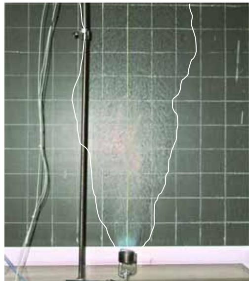
*Bild 12: Durchmischungsgebiet im Abstrom eines Brenners mit Dralldüse.*
