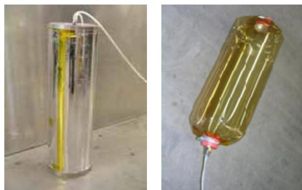
Bild 6: Schlauchproben zur Untersuchung der Dampfdichtigkeit, Beständigkeit und Festigkeit.
