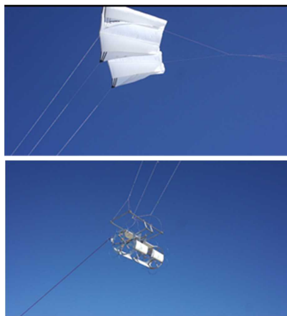
図 3 風吊り下げテザー型直線翼風車フィールド実験 (発電機地上設置・風車有型)
